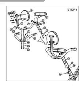
一将背垫管(3)用尼龙螺母(74),盘头方颈螺栓(72),平垫圈(23)使用鱼叉扳手固定在座垫管(12)上。
