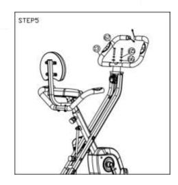
06. 先将电子表上盖(61)安装在前扶手(13) 上,将电子表线按照标签——对应连接,然后 将电子表下盖(58) 对齐电子表上盖(61),用 鱼叉扳手工具和圆头十字螺钉(59)固定好整 个电子表。
