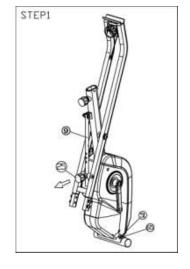
02. 用鱼叉扳手将上一步中备用的袋帽螺母(51)、 弹簧垫圈(65)和半圆头方颈螺栓(28)将前脚管(7) 固定在主架(1)下端。
